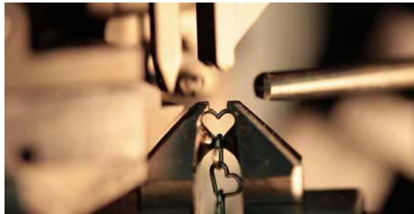
*La tipologia di saldatura più utilizzata è quella a nastro: la catena viene sgrassata e introdotta nei buratti, dove entra in contatto con la polvere di saldatura. Questa, attraverso i movimenti dello stesso, si colloca all'interno delle maglie, senza intaccare la capacità della catena di muoversi.*
